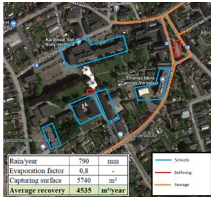
Figuur 7-28 : Innovatieproject “Markt Vorselaar” met voorstelling van de scholen en RWA-stelsel die de ondergrondse buffering onder het Marktplaats van Vorselaar zullen voeden, van waaruit de omliggende gebouwen (scholen, gemeentebouwen) water zullen kunnen gebruiken (bron: gemeente Vorselaar en Pidpa).
