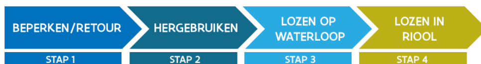
Figuur 7-33: de opeenvolgende stappen van de bemalingscascade (bron: VMM)
