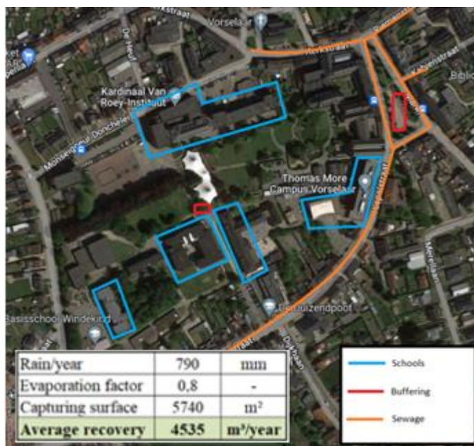
Figuur 7-30 Innovatieproject “Markt Vorselaar” met voorstelling van de scholen en RWA-stelsel die de ondergrondse buffering onder het Marktplaats van Vorselaar zullen voeden, van waaruit de omliggende gebouwen (scholen, gemeentebouwen) water zullen kunnen gebruiken (bron: gemeente Vorselaar en Pidpa).
