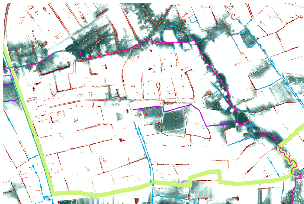
Figuur 7-14 illustratie van landschapsdepressies in het stroomgebied van de Babbelsebeek (groene zones) die worden gedraineerd via riolering of baangrachten (blauwe lijnen en pijlen, oranje stippellijnen en de lijnvormige clusters van rode pixels) die verbonden zijn met waterlopen
