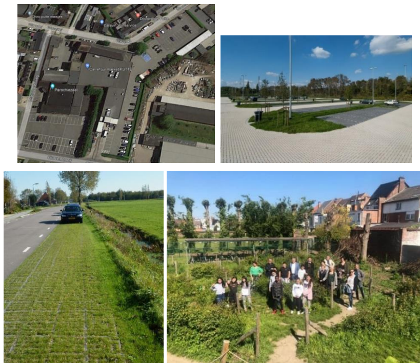
Figuur_Bijlage D-2: Voorbeelden van het toepassen van ontharden op de parking van de Carrefour te Putte (linksboven; bron: google maps) en een carpoolparking te Hasselt (rechtsboven ; bron: foto Ebema) en de ontharde speelplaats van basisschool De Knipoog te Vilvoorde (rechtsonder; bron: Provincie Vlaams-Brabant, 2019))
