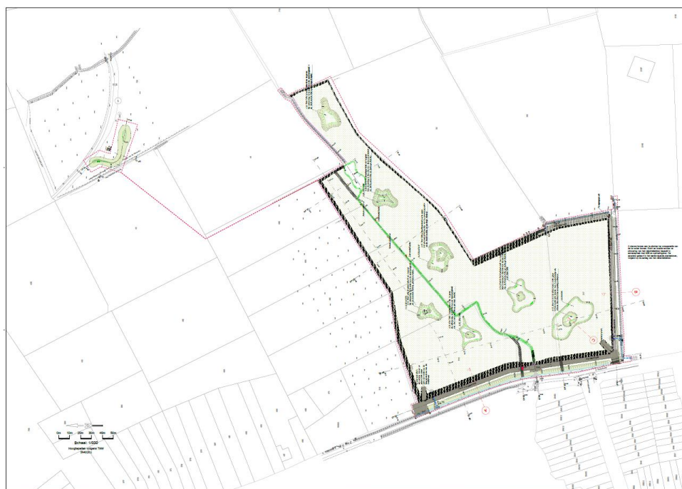
Figuur 4-4 : Aanleg retentiebekkens opwaarts Wullebeek.
