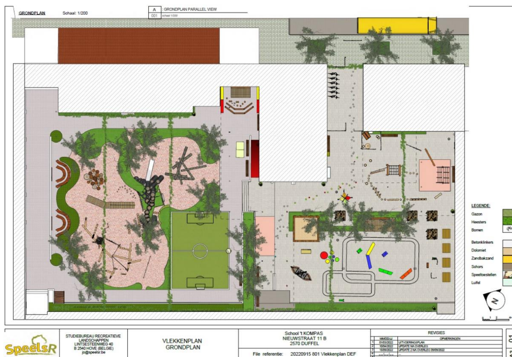
Figuur 7-3 : Voorbeeld van het ontwerp van de ontharde speelplaats van basisschool 't Kompas te Duffel (Vlekkenplan, bron: gemeente Duffel)
