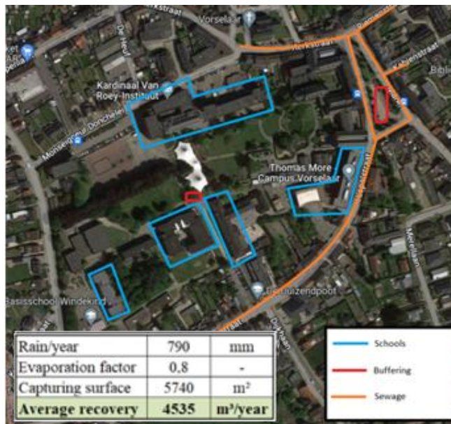
Figuur 7-25 : Innovatieproject “Markt Vorselaar” met voorstelling van de scholen en RWA-stelsel die de ondergrondse buffering onder het Marktplein van Vorselaar zullen voeden, van waaruit de omliggende gebouwen (scholen, gemeentegebouwen) water zullen kunnen gebruiken (bron: gemeente Vorselaar en Pidpa).
