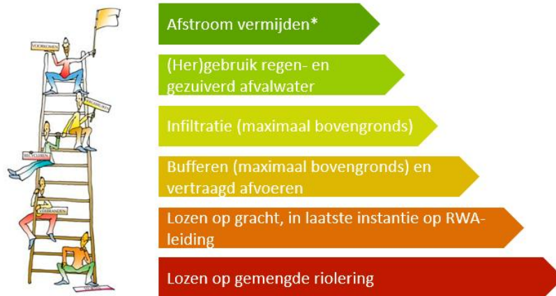
Figuur 1-2. Principes van duurzaam waterbeheer weergegeven op de "Ladder van Lansink" met onder meer de brongerichte omgang met hemelwater (*Afstroom vermijden kan door verharding te beperken, drainage te verminderen, .....) (bron: Coördinatiecommissie Integraal Waterbeleid, 2021)
