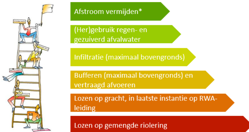
Figuur 1-2 : Principes van duurzaam waterbeheer weergegeven op de “Ladder van Lansink” met onder meer de brongerichte omgang met hemelwater (*Afstroom vermijden kan door verharding te beperken, drainage te verminderen , etc.) (CIW, 2021)
