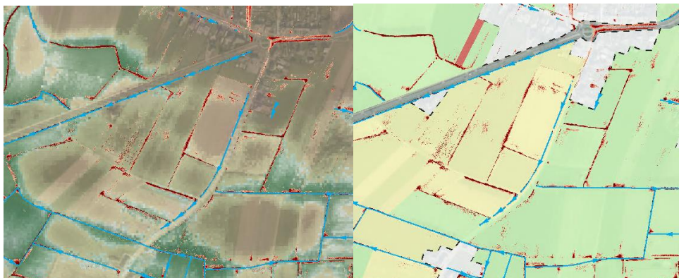
Figuur 7-12 : Detailbeeld van mogelijke locaties voor infiltratiepoelen op een hoger gelegen infiltratiegebied (links; bruin-gele zones). Op de landgebruikskaart is evenwel te zien dat sommige percelen (rechts; lichtgroen) onder wei- of hooiland liggen. Afstroming zal vooral een probleem zijn bij akkerbouw (rechts; geel).
