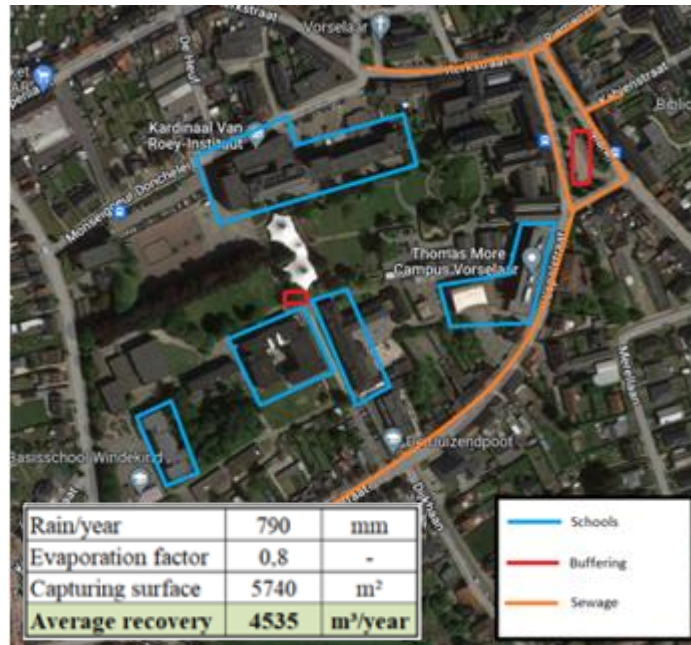
Figuur 7-30 : Innovatieproject “Markt Vorselaar” met voorstelling van de scholen en RWA-stelsel die de ondergrondse buffering onder het Marktplaats van Vorselaar zullen voeden, van waaruit de omliggende gebouwen (scholen, gemeentegebouwen) water zullen kunnen gebruiken (bron: gemeente Vorselaar en Pidpa).
