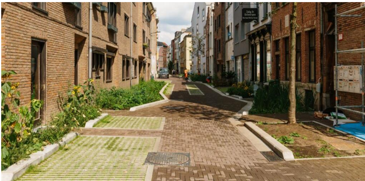
Figuur 25. Voorbeeld van de volledig ontharde plantvakken en halfverharde parkeervakken in een tuinstraat (Lange Riddersstraat) in Antwerpen (Bron: Stad Antwerpen).
